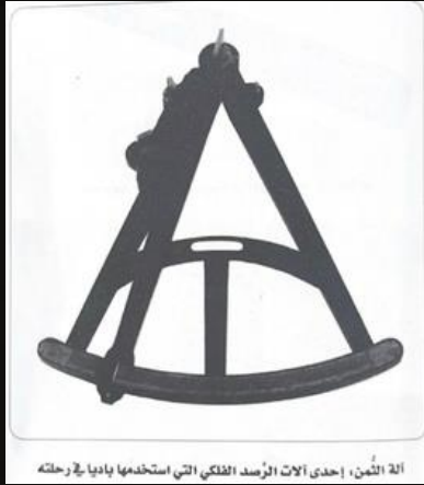
آلة الثمن، إحدى آلات الرصد الفلكي التي استخدمها باي في رحلته
